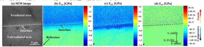
パワー半導体である4H-SiCのイオン注入した界面に生じた残留弾性歪の3次元可視化 引用:Acta Materialia 221(2012)116845,
